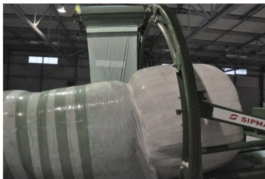
Fot. 3. Bele w trakcie procesu owijania folią Źródło: ze zbiorów SIPMA S.A.
