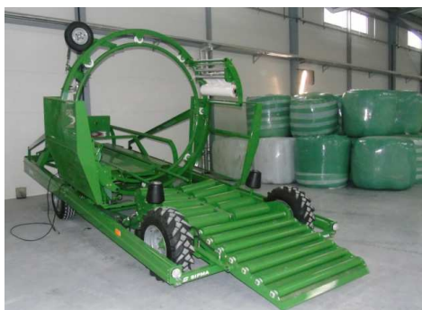
Fot. 1. Prototyp owijarki szeregowej do bel zielonki SIPMA OG 9750 LENA
