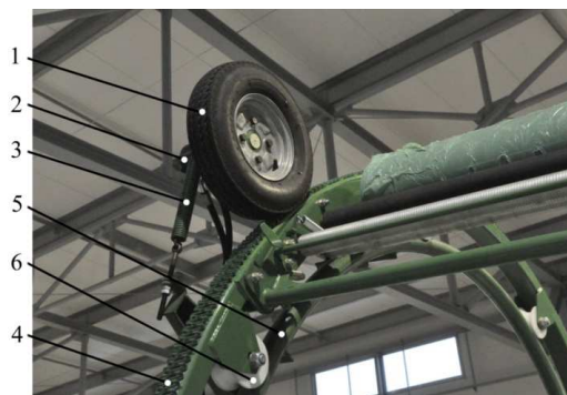
Fot. 5. Napęd pierścienia owijającego: 1 – koło napędowe, 2 – silnik hydrauliczny OMR 100, 3 – sprężyna, 4 – występy, 5 – nieruchomy pierścień prowadzący, 6 – rolka
